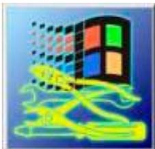
Выберите этот значок в меню «Техническое обслуживание», чтобы получить доступ к инструментам, необходимым для работы с некоторыми важными функциями Windows™, когда операционная система переведена в режим «без рабочего стола». Режим «без рабочего стола» установлен по умолчанию на новом станде при установке программного обеспечения. Эта функция ограничивает доступ к операционной системе Windows™.
