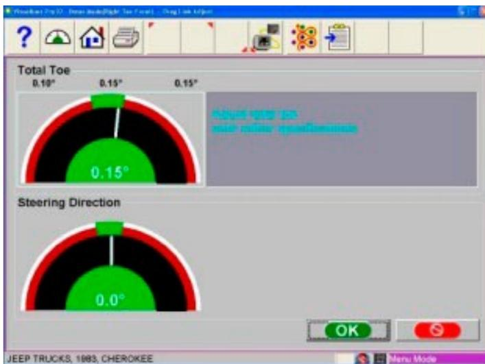
На экранах настройки продольной рулевой тяги отображаются измеритель общего схождения и индикатор направления рулевого управления. Для правильной настройки выполните следующие действия:
